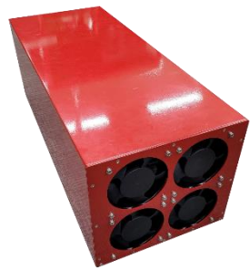
15kV, 10kA 대용량 스위치 시작품
