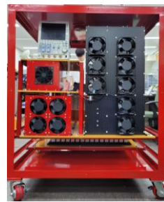
가속기용 Solid-state Kicker Modulator 시작품
