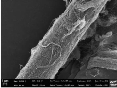
복합체 제조 이전의 촉매성장 CF-MWCNT의 SEM 이미지
